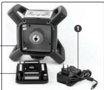
**Nota:** È possibile caricare il pacco batteria ricaricabile all'interno o all'esterno della livella laser. Il laser rotante può essere utilizzato durante la ricarica. Ci vogliono circa sette ore per ricaricare completamente le batterie. Sono necessari tre cicli di carica/scarica completi affinché le batterie nuove o non utilizzate raggiungano la completa capacità.
